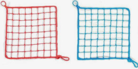
**SAM A50** Maschenweite 50 x 50 mm, 10/12 mm Randseil, Befestigungskauschen an den Enden, Farbe ROT u. BLAU. Kordelstärke 5 mm. Geknotetes Netz aus Polyethylen, thermofixiert, UV stabilisiert.
